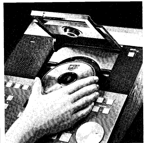
Top-Loader mit Schacht für normale CDs und 8 cm-Singles
