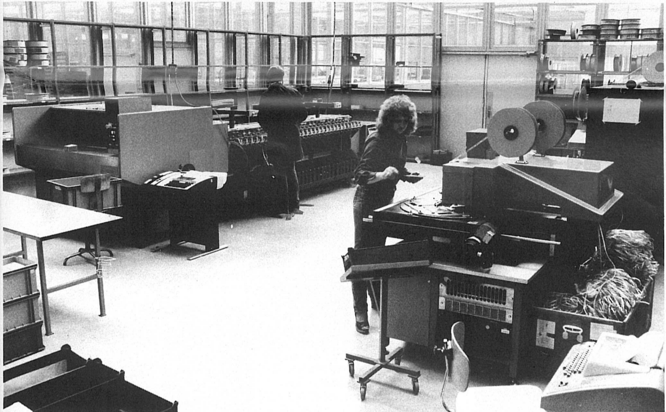
Beinahe "totale automatische Bestückung" mit Axial- und Radialbestückungsmaschinen.
