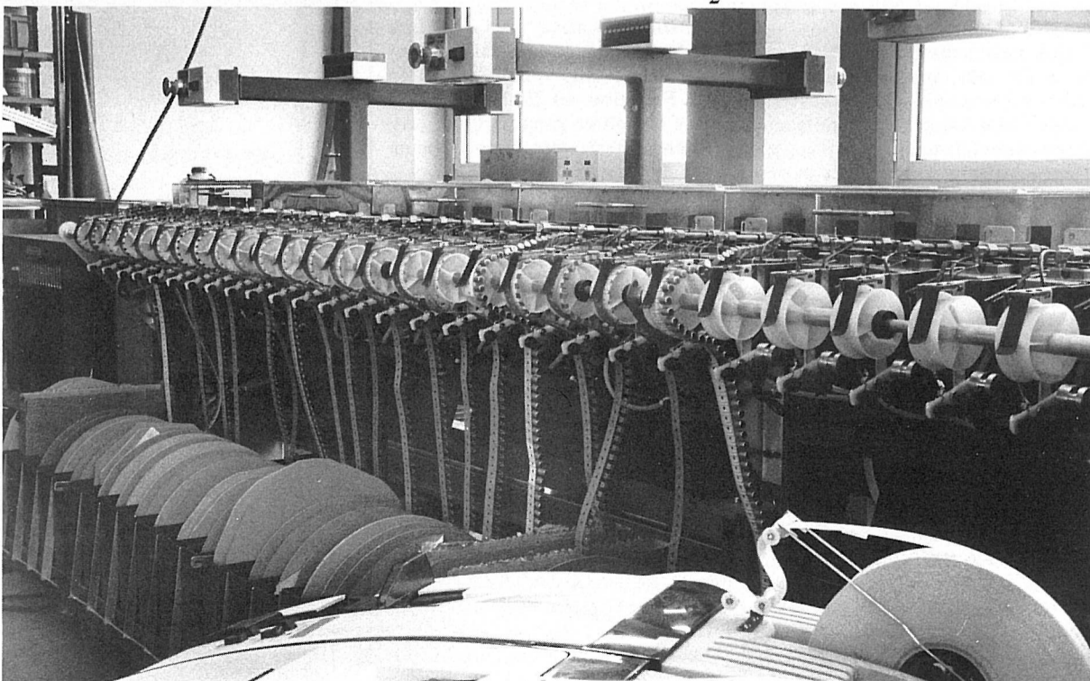
Sequenzer mit radialen Gurten geladen. Im Vordergrund das Teletype-Gerät.
